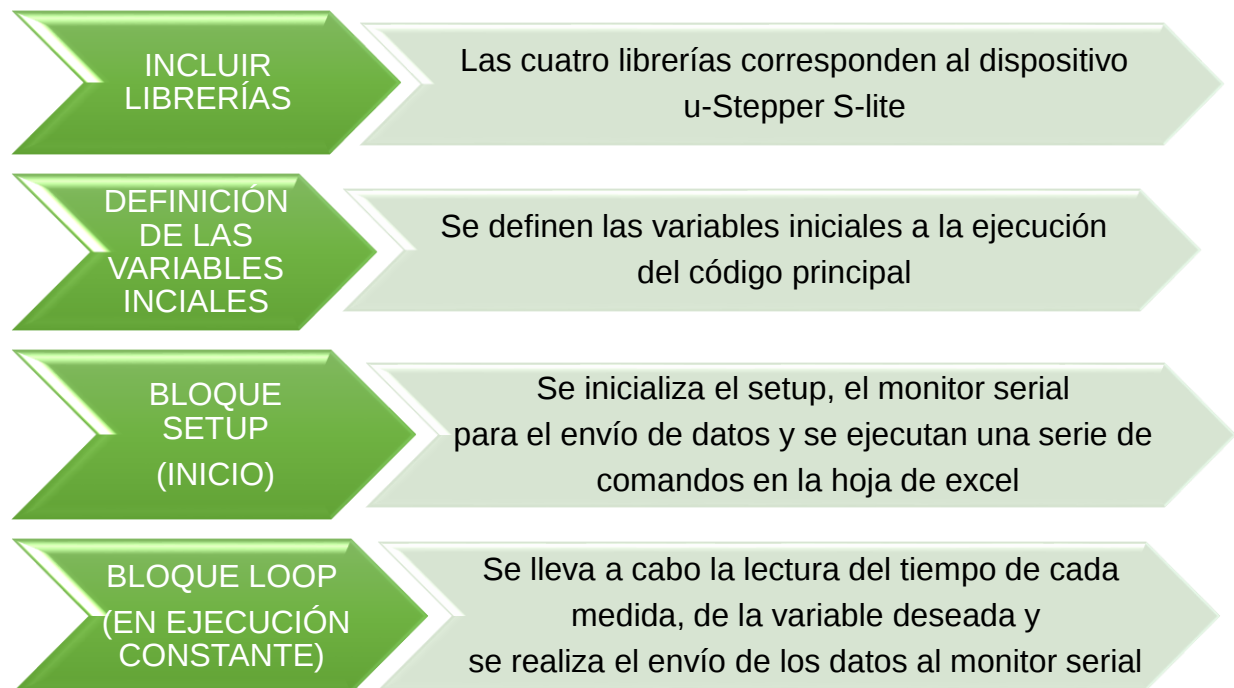
Figura 2.9. Estructura del código de programación ARDUINO-EXCEL
