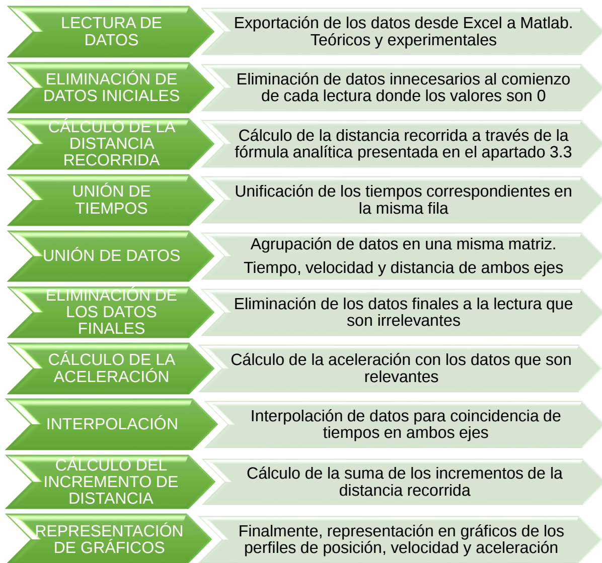
Figura 4.3. Estructura del código de programación para el procesamiento de los datos en vacío
