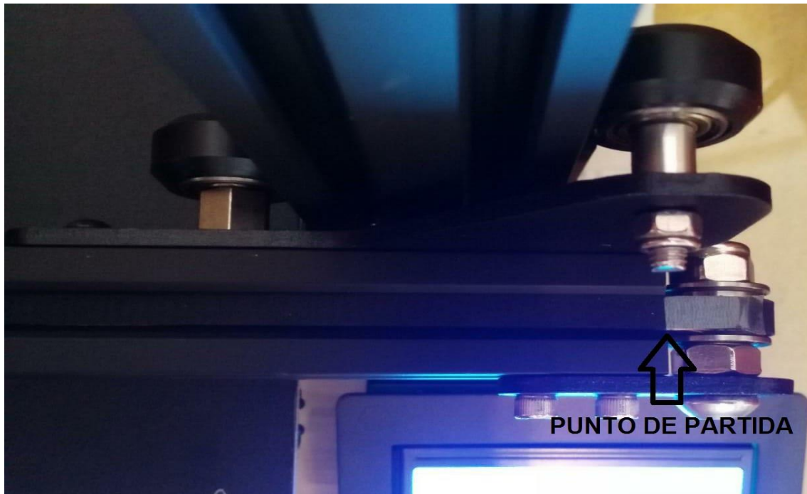
Figura 3.9. Punto de partida para la medición de la distancia experimental en el eje X.
