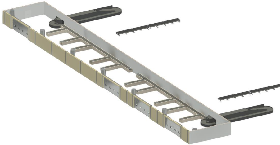
Figura 63. Detalle del cerramiento exterior de la zona de tratamiento de equipaje del vestíbulo inferior de llegadas.
