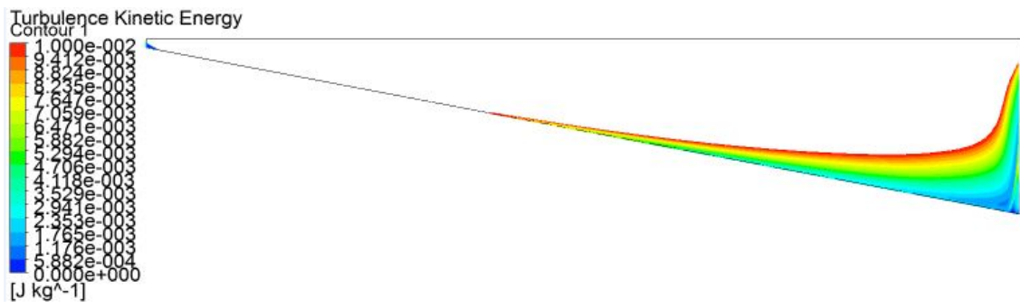
Fig 4.23. Isocontornos para distintos rangos de k, con un caudal de 1250m 2 /s. a) k=min/max, b) k=1/7.7, c) 0.1/1, d) k=0.01/0.1, e) k=0/0.01
