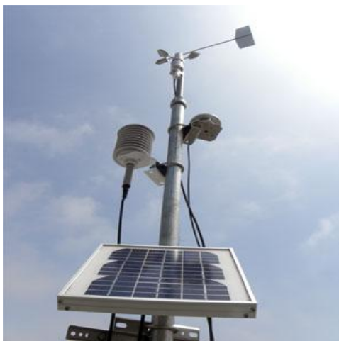
Estación meteorológica que mide los contaminantes atmosféricos además de las variables meteorológicas (Fuente: google imágenes).
