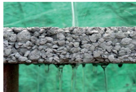
Figura 1 y Fig 2: Utilización de materiales permeables en la subcapa de la superficie (grava, arenas) en forma de matriz propician el crecimiento de especies herbáceas y se consigue aumentar en gran medida la capacidad de infiltración. Fuente: (Krauze and Wagner, 2014).
