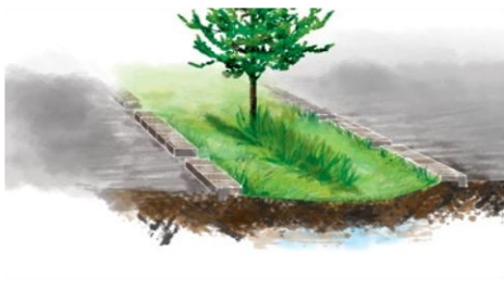
Ejemplo de una hendidura en la acera para canalizar el agua procedente de escorrentía de la vegetación, en Portland, E.E.U.U. Fuente: (Krauze and Wagner, 2014).
