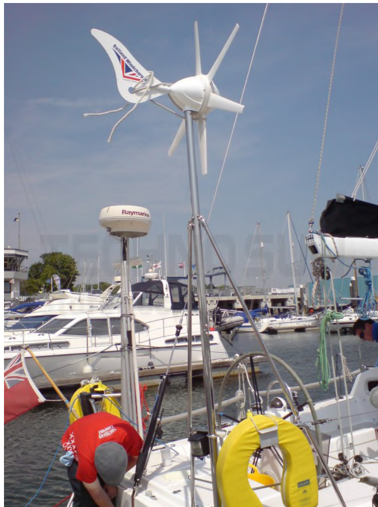
Figura 2.30. – Aerogenerador Marlec Rutland 914 instalado en un velero. Fuente [28]
