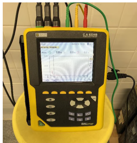
Figura 4.12 – Analizador de redes. Fuente propia.
