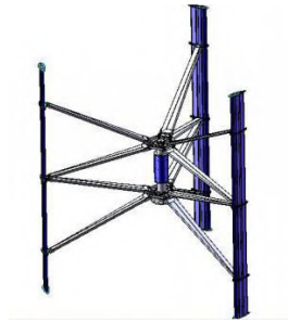
Figura 2.11. – Turbina aerogenerador vista vertical. Fuente [7]
