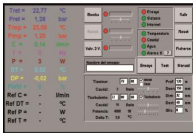
Figura 2.1: Pantalla de control del sistema antes del inicio del ensayo [1].
