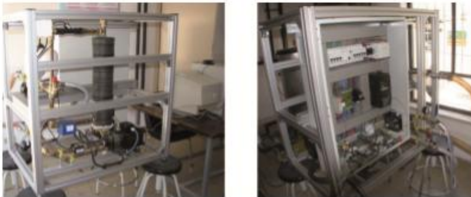
Figura 2.9: Vistas anterior y posterior del equipo desarrollado mostrando circuitos hidráulico y eléctrico [1].
