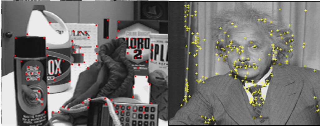
Ilustración 1-19. Detectores de esquinas y puntos característicos: a) Harris; b) SIFT (tomada de (Chen, et al., 2012)); b: SIFT (tomada de (Lowe, 2004)).
