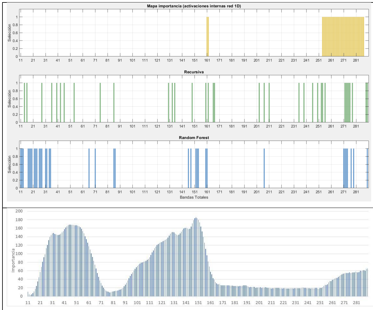
Ilustración 3-49. Selección de características mediante diversos métodos: mapa de importancia (red 1D); eliminación recursiva; bosques aleatorios; análisis de la varianza (ANOVA) para los niveles de lambda-cihalotrina.
