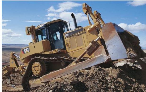
Foto 13: Tractor de cadenas D7R
