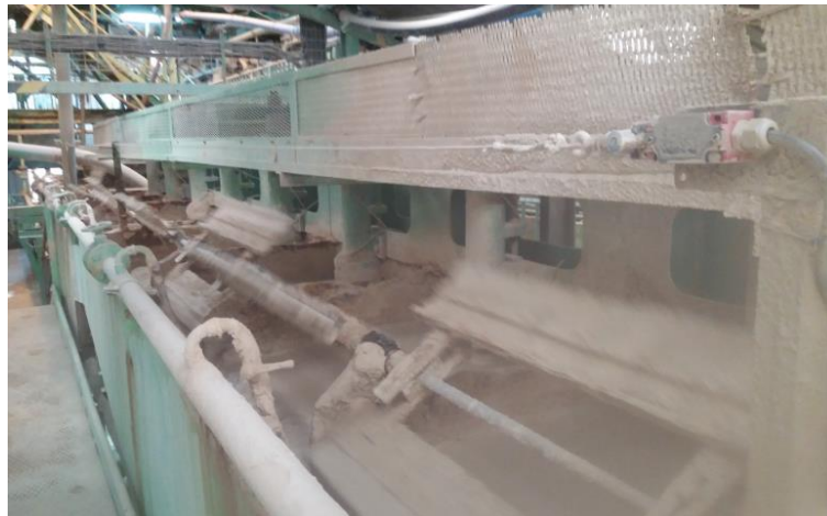
Foto 47: Segunda fase o Deslamado que consta de 60 celdas circulares
