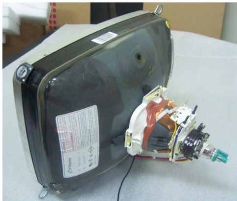
Foto 7: Tubo de rayos catódicos de una pantalla [Blue tooth7 / CC Attribution-Sharealike 3.0 License].
