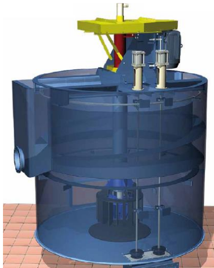
Figura 9: Celda de flotación RCS (Sistemas de Celda de Reactor)
