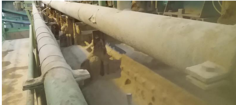
Foto 46: Primera fase o Desbaste que consta de 40 celdas circulares
