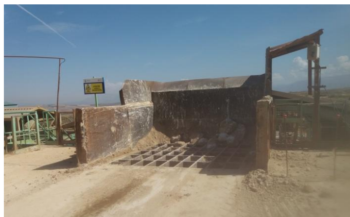
Foto 20: Parrilla separadora de los bloques 300 x 300 mm
