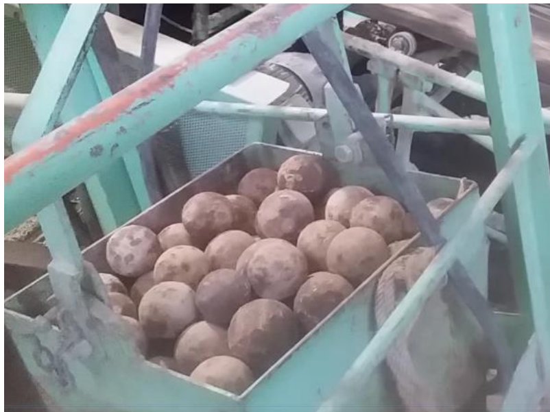
Foto 40: Bolas de diámetro de 90 mm
