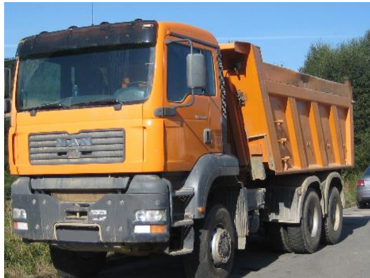
Foto 16: Volquete rígido de 4 ejes
