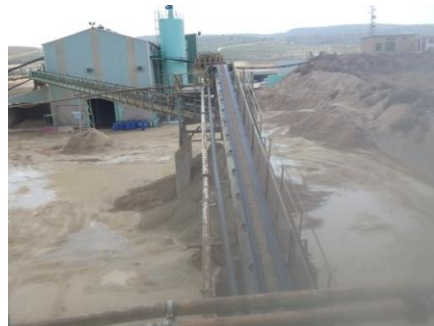
Foto 30: Cinta de acopio de preconcentrado
