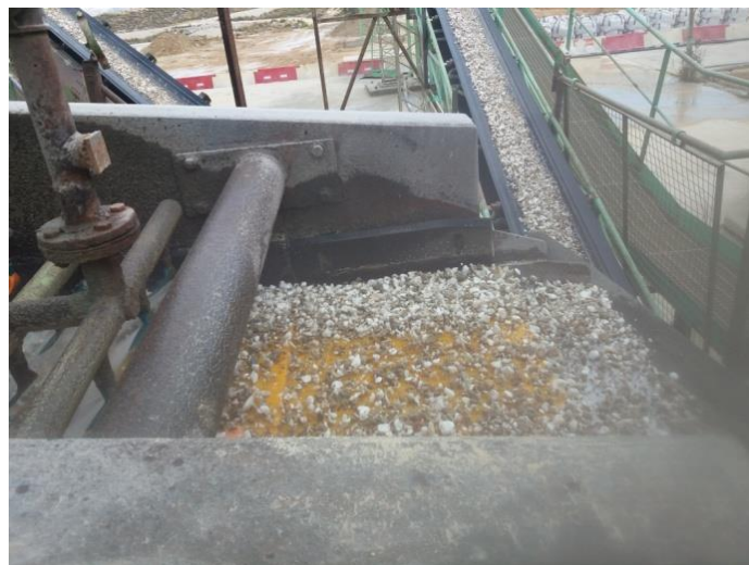
Foto 38: Salida del yeso y la calcita por el "Over" del ciclón
