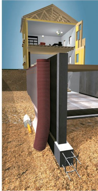
Ilustración 2. 44 Ejemplo montaje capa impermeable
