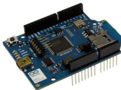
Ilustración 5. Shield WiFi modelo 2 para Arduino.
