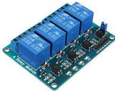
Ilustración 8. Shield de relés para Arduino.
