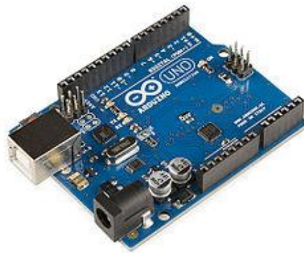
Ilustración 4. Tarjeta de desarrollo Arduino UNO.
