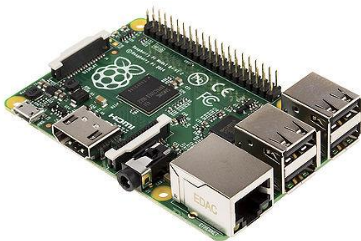
Ilustración 2. Tarjeta de desarrollo Raspberry-Pi.
