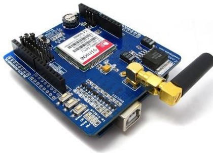
Ilustración 7. Shield para comunicaciones GSM/GPRS.
