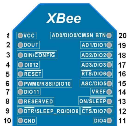
Figura 12 Patillaje módulo Zigbee
