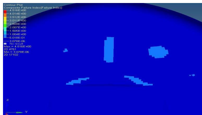
Figura 9.2 – Índice de fallo en área superior
