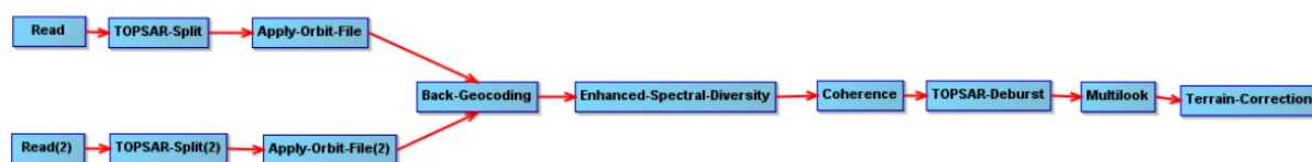
Figura 9: Diagrama de flujo del pre-procesamiento de las imágenes de Sentinel-1
