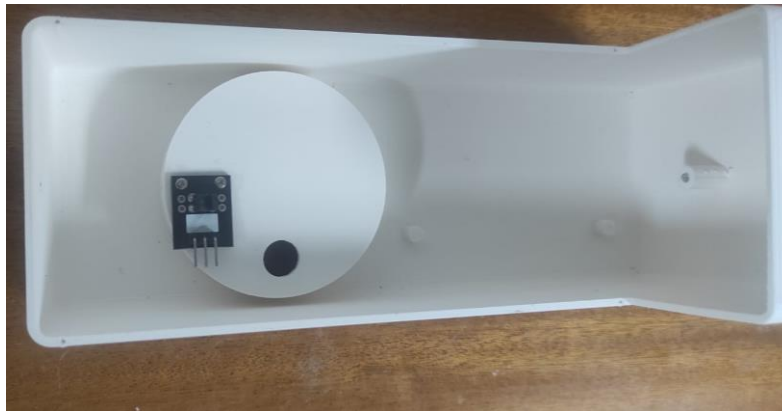
Figura 26. Montaje del fotointerruptor.
