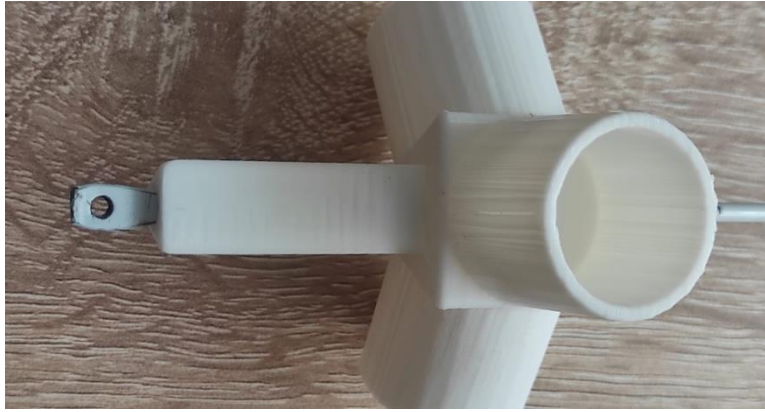
Figura 23. Introducción de la varilla en el buje.
