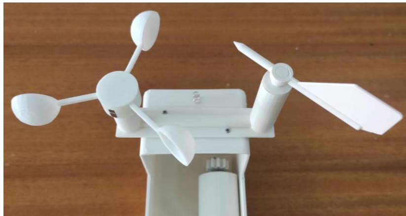
Figura 29. Conjunto anemómetro-veleta finalizado.
