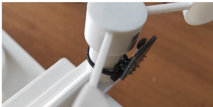
Figura 30. Montaje sensor Hall.
