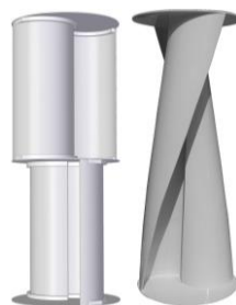
Figura 2. Aerogenerador Savonius de palas rectas (izda.) y helicoidales (dcha.) [9].
