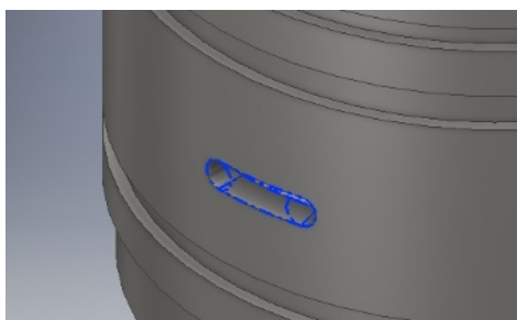
Ilustración 238. Extrusión en la cubierta externa del cilindro.
