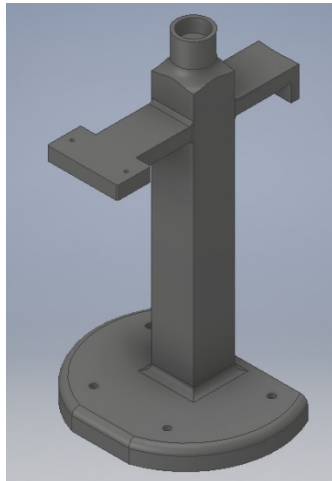
Ilustración 153. Extrusión de plataforma en soporte m.
