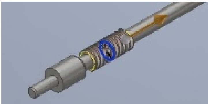
Ilustración 131. Detalle de un cilindro de referencia en el tornillo del eje del sinfín.
