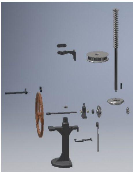
Ilustración 274. Inserción del conjunto de piezas del sistema mecánico.
