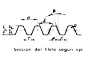
Ilustración 79. Esquema representativo de la sección de la corona [5].
