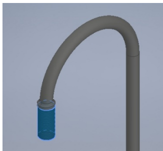
Ilustración 206. Extrusión de cilindro roscado en la grúa giratoria B.
