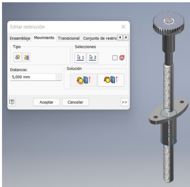
Ilustración 28. Restricción de movimiento de rotación-traslación.
