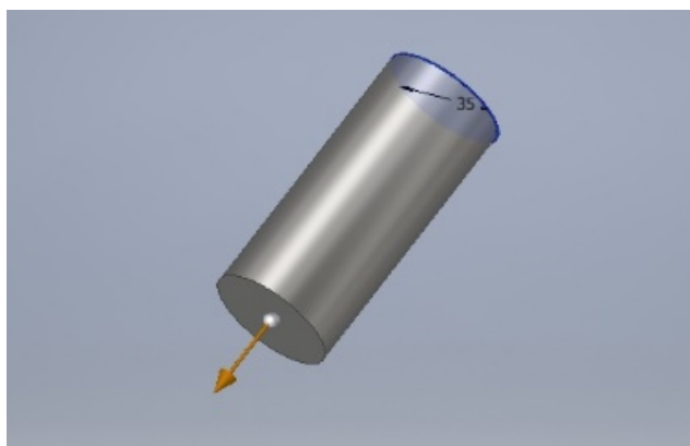
Ilustración 87. Extrusión del cilindro del sinfín.
