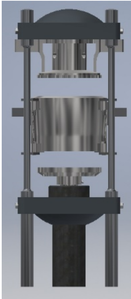
Ilustración 129. Inserción del plato compresor superior a la estructura.
