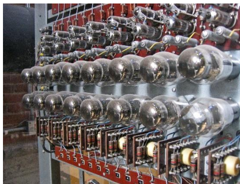
1. Válvulas de vacío en ENIAC. Recuperado de museo.inf.upv.es/es/eniac/
