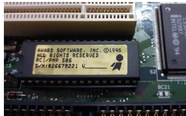
9. Circuito integrado de la BIOS. Elaboración propia
