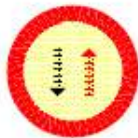
TR-5 PRIORIDAD AL SENTIDO CONTRARIO
