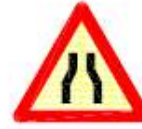
TP-17 ESTRECHAMIENTO DE CALZADA
