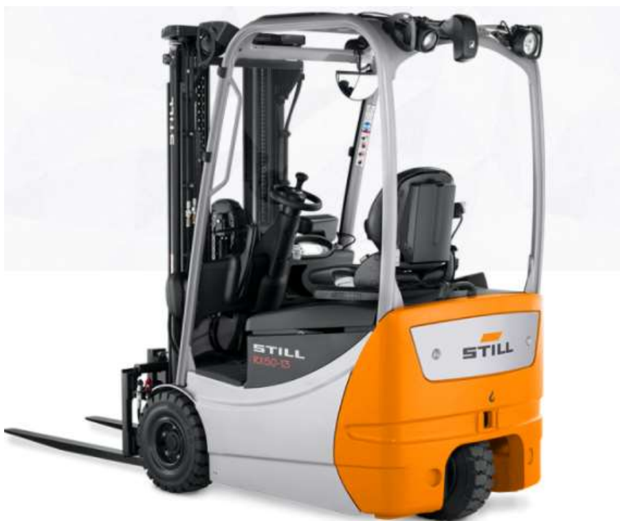
Figura 17: Carretilla contrapesada eléctrica
