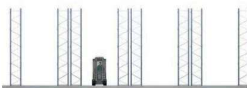
Figura 18: Estanterías metálicas de doble fondo para almacén de palets
