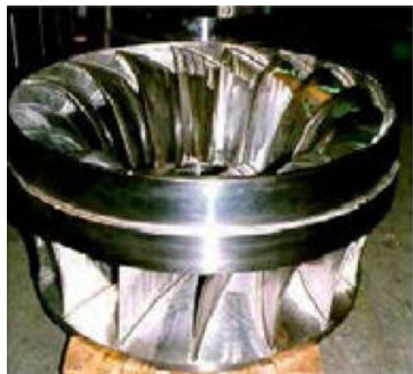
Figura 6.11 foto de un anillo accionador Figura 6.12 fotografía del rodete de una Francis
