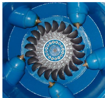
Figura 6.4 5 inyectores verticales Figura 6.5 2 inyectores horizontales
