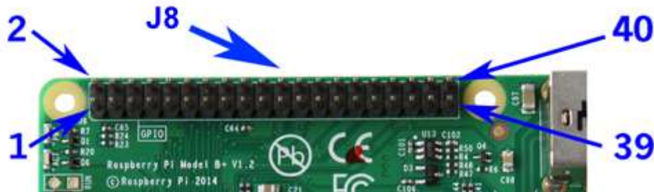
Figura 2.5 Expansión pines Raspberry Pi 3 Model B
