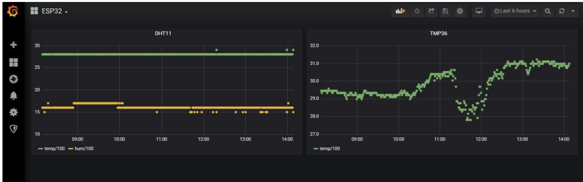
Figura 5.7 Datos con dos paneles de los dos sensores con Grafana
