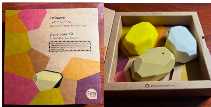
Figura 14. Kit de desarrollo de balizas UWB Estimote (izquierda) y contenido del kit (derecha).
