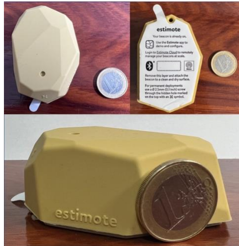
Figura 15. Comparación del tamaño de una baliza UWB de Estimote con una moneda de 1€.
