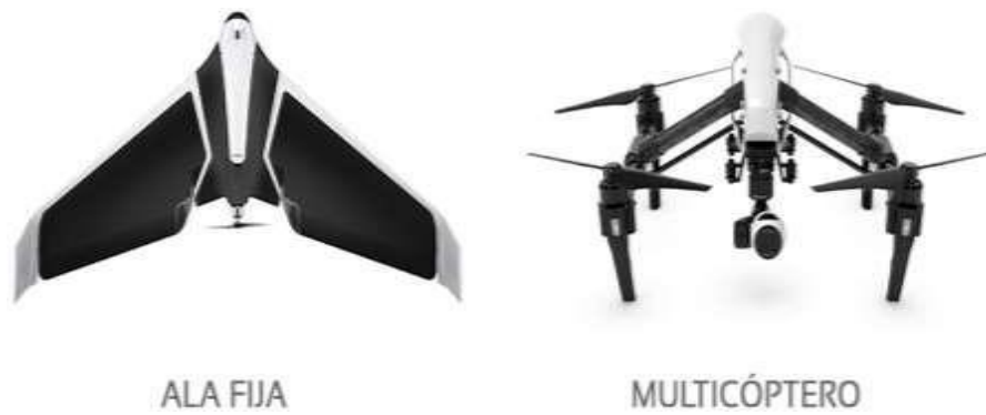
Figura 19-Dron Ala Fija y multirrotor
