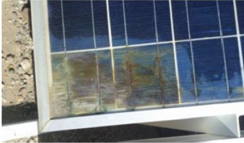
Figura 17-Placa con corrosión Fuente: Morales (2020)
