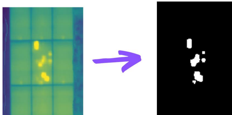
Figura 48-Clasificación de las anomalías en la placa (Extensión) Fuente: Elaboración Propia
