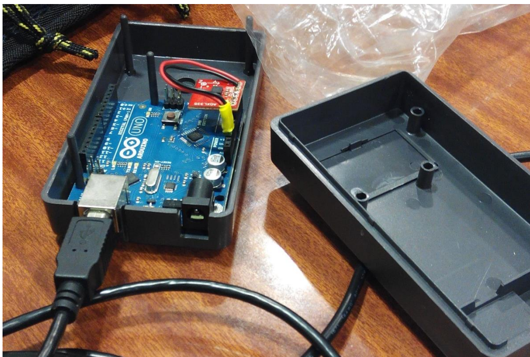
FIGURA 5.10.- Arduino con acelerómetro colocado dentro de su caja.- Fotografía propia.
