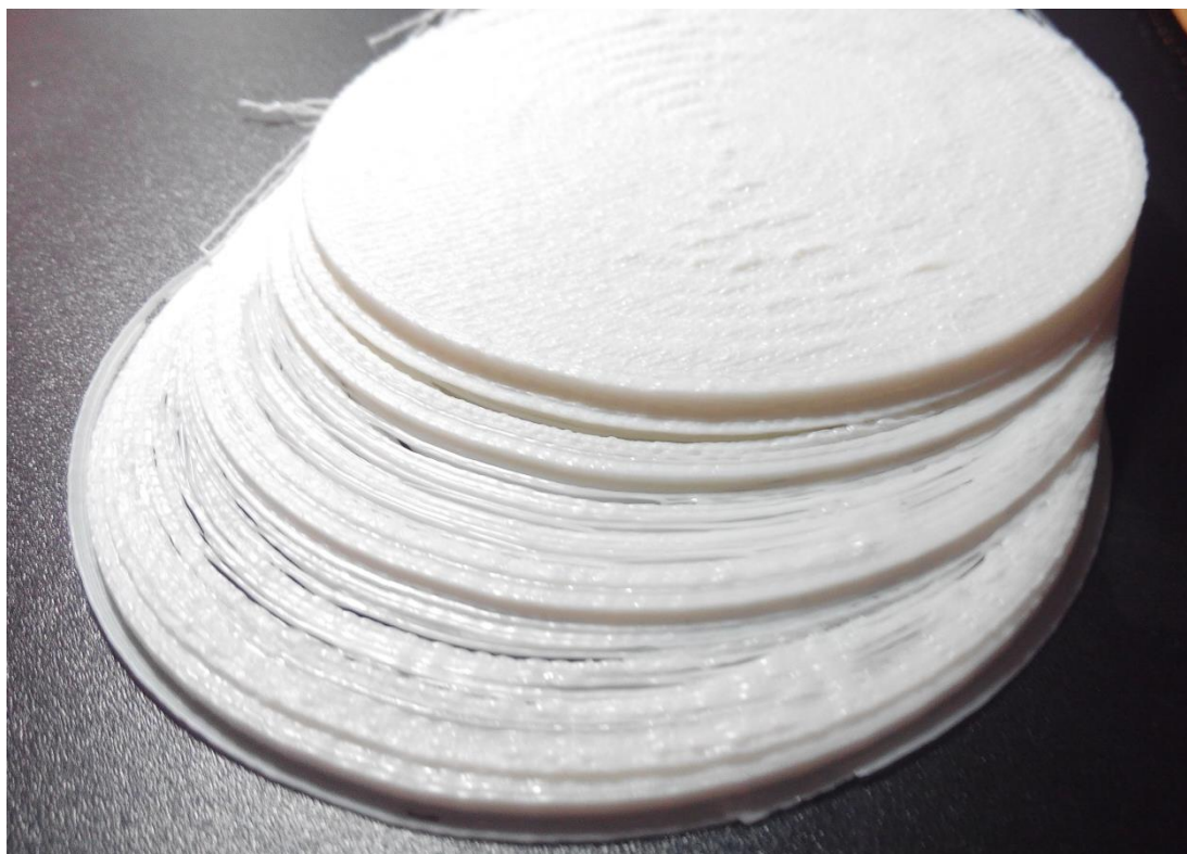
FIGURA 5.4.- Vista de planta de probeta impresa con una altura de capa de 0,1 mm a 60 mm/s.- Foto propia.
