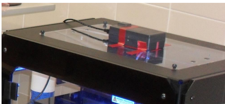
FIGURA 5.11.- Caja con Arduino colocada en la zona superior de la impresora.- Fotografía propia.
