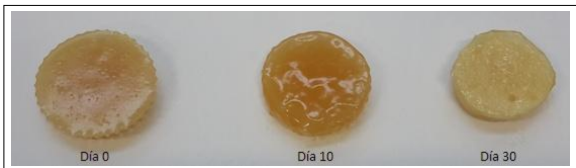
Proceso de degradación en condiciones ambiente. Polímero Cruda 1:2. Figura 5.17.
