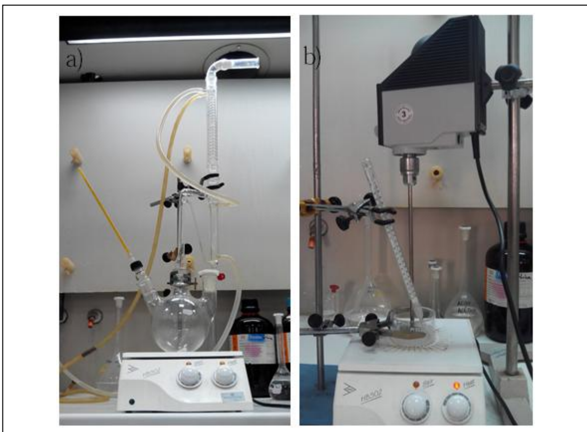
Montaje del equipo para la síntesis del polímero. a) Relación 1:2. b) Relación 1:1
