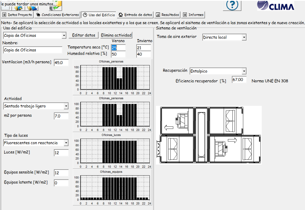
Figura 6.2 Uso del edificio y sistemas de ventilación
