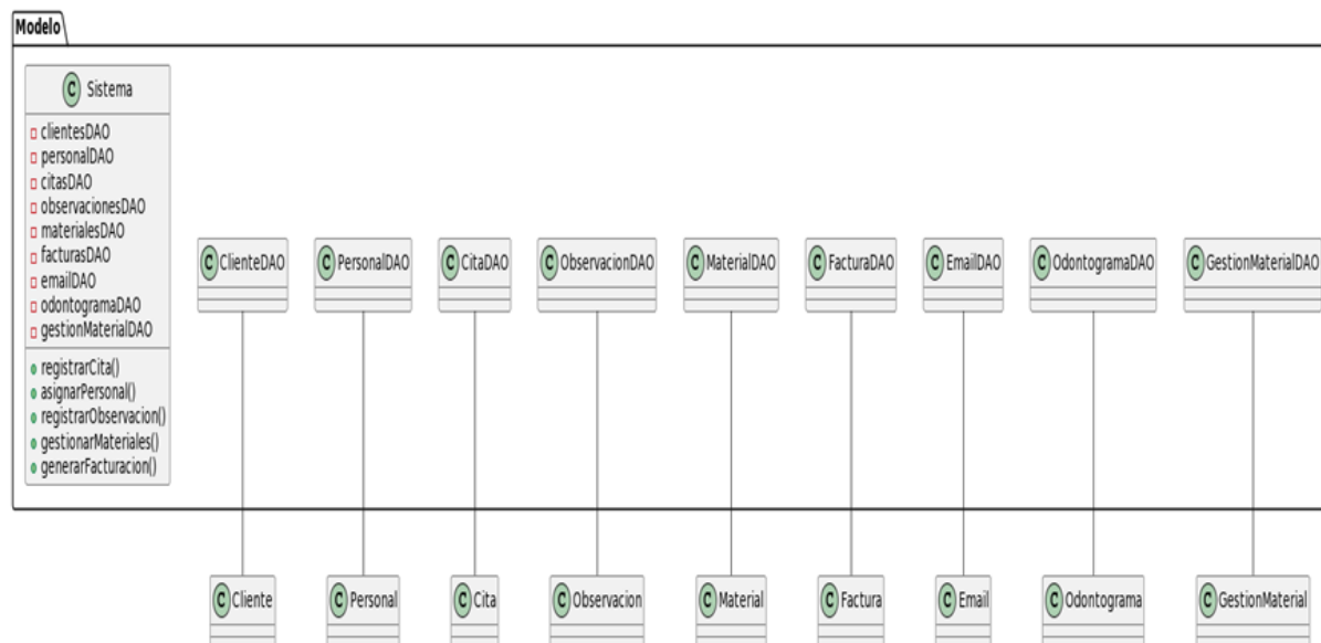
Ilustración 6: Diagrama MVC Modelo de clases
