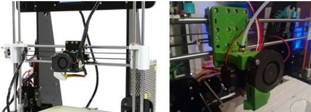
Figura 5.5 (izqda.) extrusión directa (tomada de portachiavi.es/producto/impresora-anet-a8-con-mejoras/ ); (dcha.) extrusión indirecta
