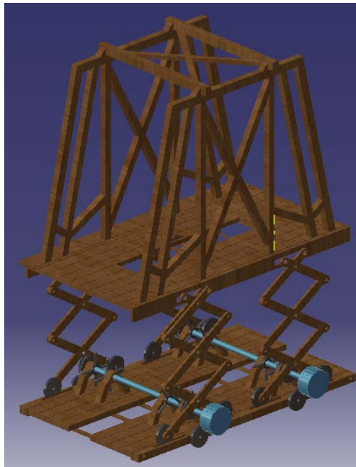
Figura 4.25 Modificación (en azul) del diseño original para posibilitar el manejo desde fuera
