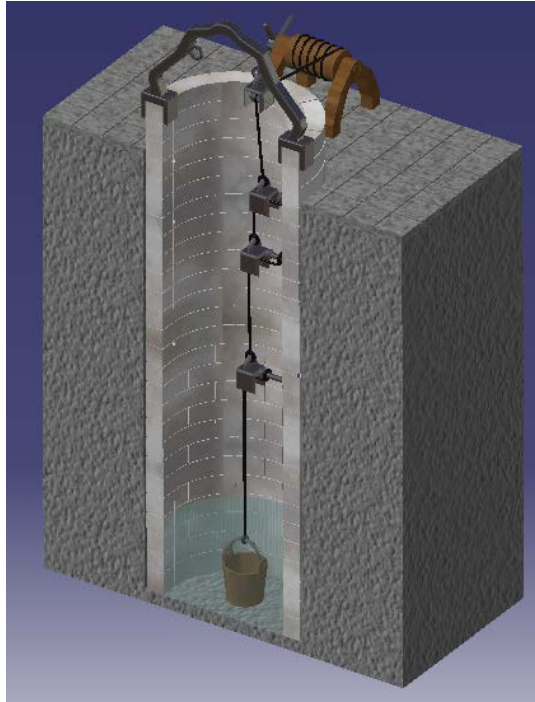
Figura 4.30 Ensamblaje del pozo
