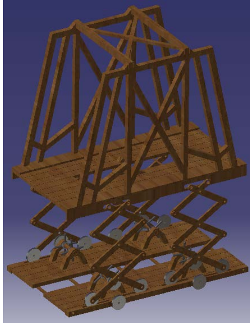
Figura 4.21 Ensamblaje de la plataforma que transportará el ariete
