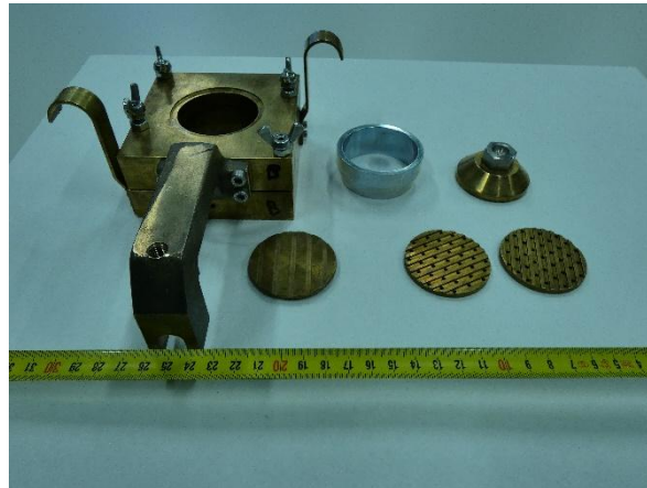
Fig. 4.13. Caja y Placas porosas y ranuradas. (laboratorio de Geología Aplicada, Campus Linares).
