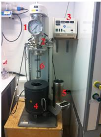
Figura 39. Reactor Parr utilizado para el pretratamiento. Fuente: autor. Datos: 1 - Manómetro; 2 - Termopar; 3 - Controlador de temperatura y agitación; 4 - Camisa de calefacción; 5 - Vaso de reacción; 6 - Sistema de agitación.
