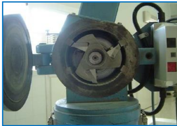
Figura 37. Molino tipo Retsch, modelo SM 100, utilizado para la molienda de la poda de olivo. Fuente: Autor.
