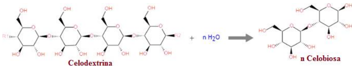
Figura 22. Producción de unidades de celobiosa por la acción de la enzima exoglucanasa. Fuente: adaptado de Aditiya et al. (2016).
