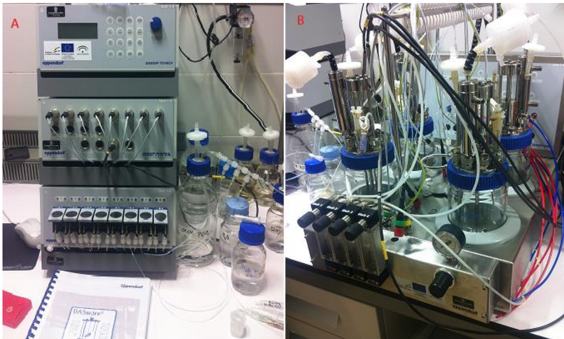
Figura 44. Equipo de fermentación empleado para fermentar el slurry con aireación. "A": controladores DASGIP TC4SC4 (control de temperatura y agitación), DASGIP PHPO (control de pH y oxígeno disuelto) y DASGIP MP8 (control del bombeo de base); "B": DASGIP Bioblock con 4 posiciones, donde fueron realizadas las fermentaciones con aireación del slurry . Fuente: Autor.
