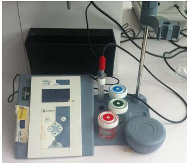
Figura 40. pHmetro digital utilizado en los ensayos. Los recipientes rojo, verde y azul contienen solución con pH conocido, destinados a la calibración del equipo. Fuente: Autor.
