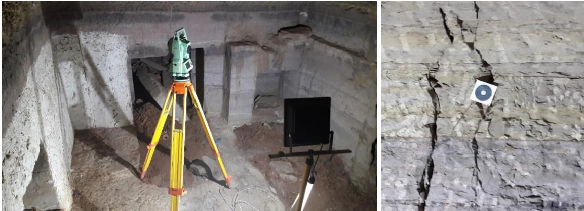
Figura 41. Colocación y medida de la diana.
