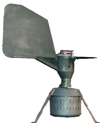
Ilustración 2.16 Captador de polen tipo Hirst
