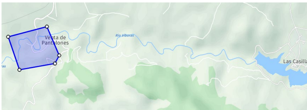
Imagen 3.3.1.1 Situación de estación foronómica 5082. Superficie de la cuenca 208 km 2 Fuente: Google Maps
