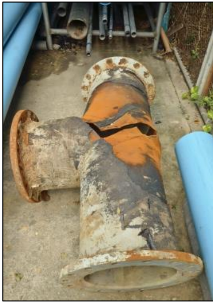
Figuras 5.4 y 5.5 Efectos del golpe de ariete en tuberías
