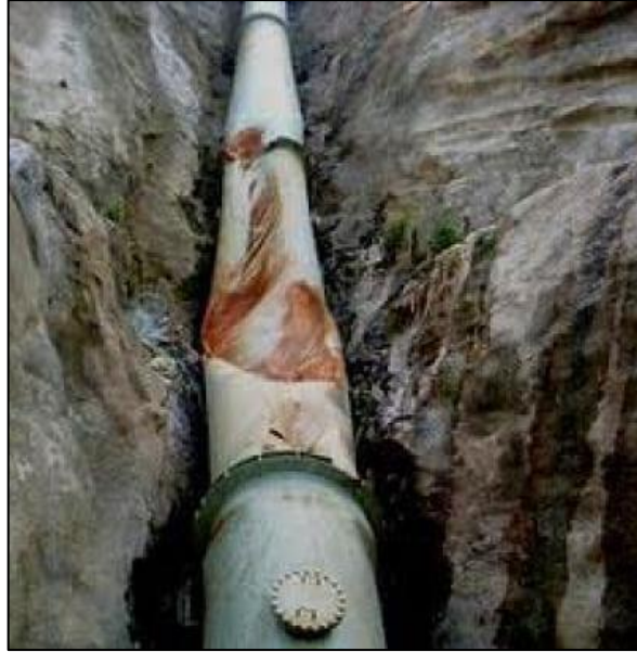
Figuras 5.4 y 5.5 Efectos del golpe de ariete en tuberías
