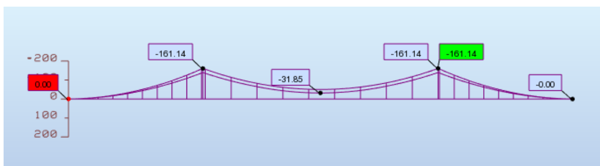
Figura 5.47. Ley de momento flector en ELU para una barra transversal del modelo
