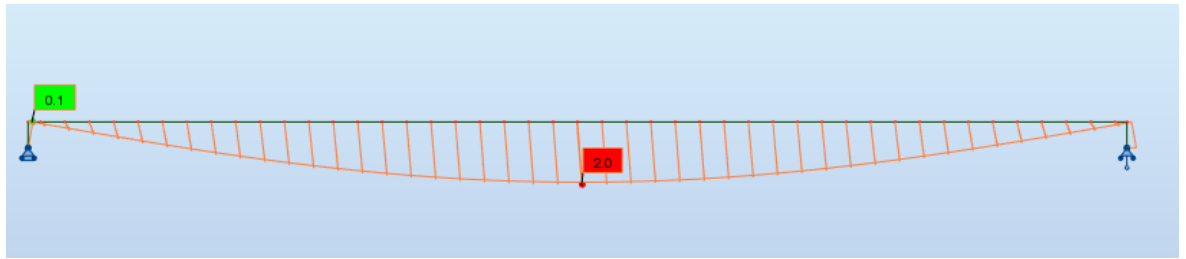
Figura 4.40 Diagrama de deformaciones y valor de flecha máxima
