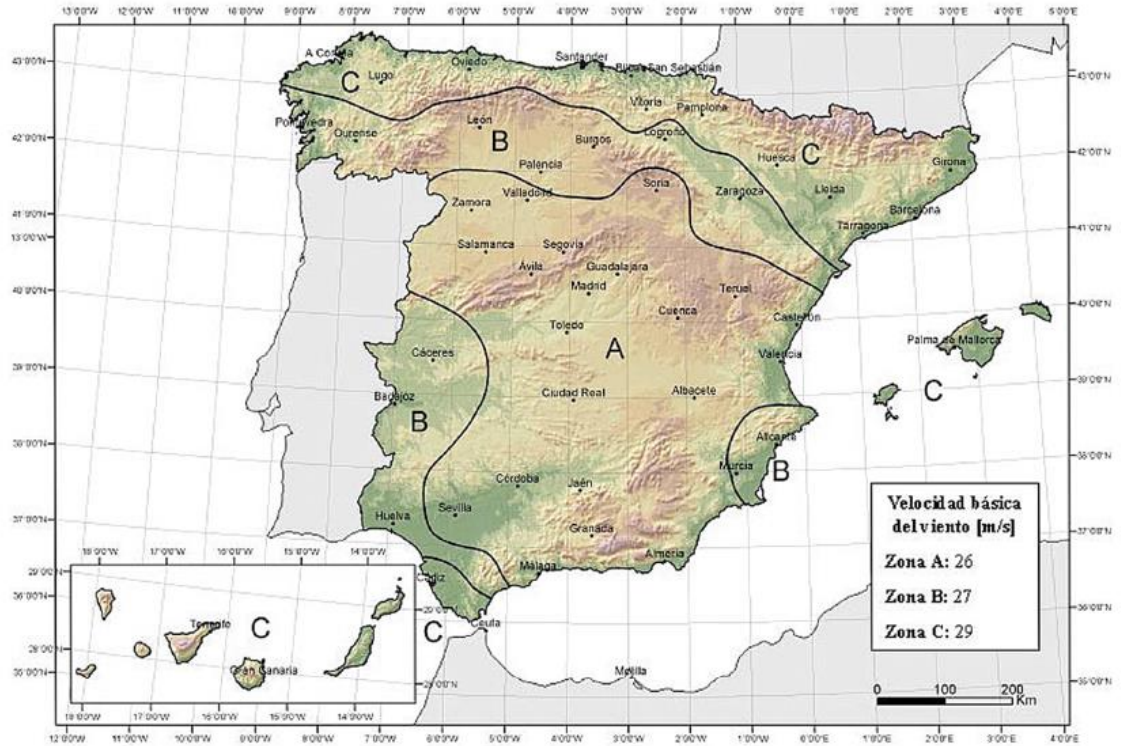
Figura 4.22 Mapa de isotacas para la obtención de la velocidad básica fundamental del viento v_{b,0} [7]
