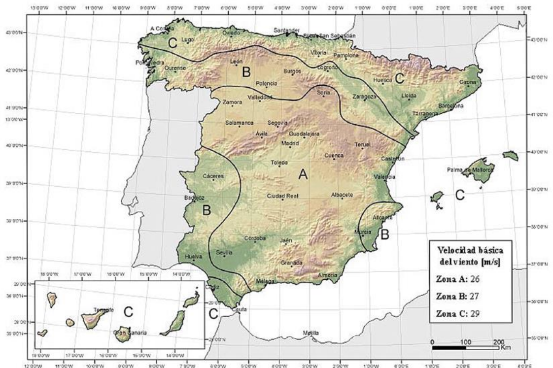
Figura 6.16 Mapa de isotacas para la obtención de la velocidad básica fundamental del viento v_{b,0} [7]
