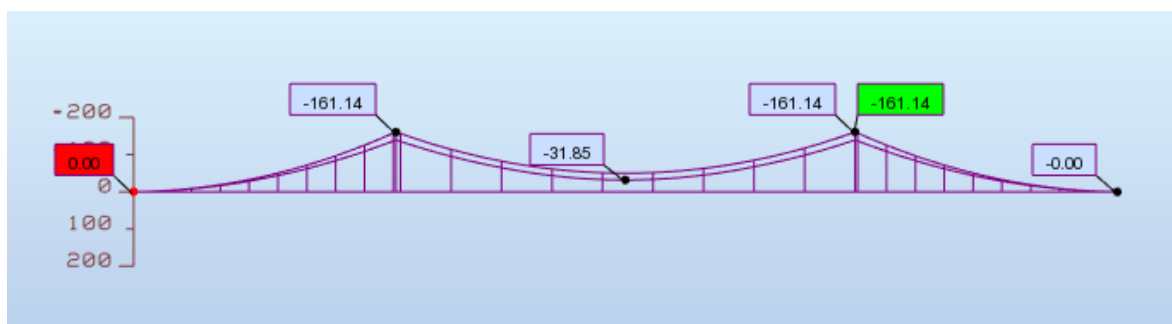
Figura 4.49. Ley de momento flector en ELU para una barra transversal del modelo
