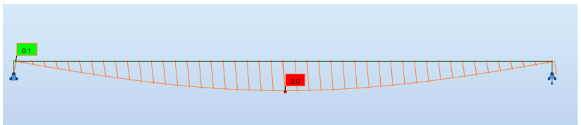
Figura 6.33 Diagrama de deformaciones y valor de flecha máxima
