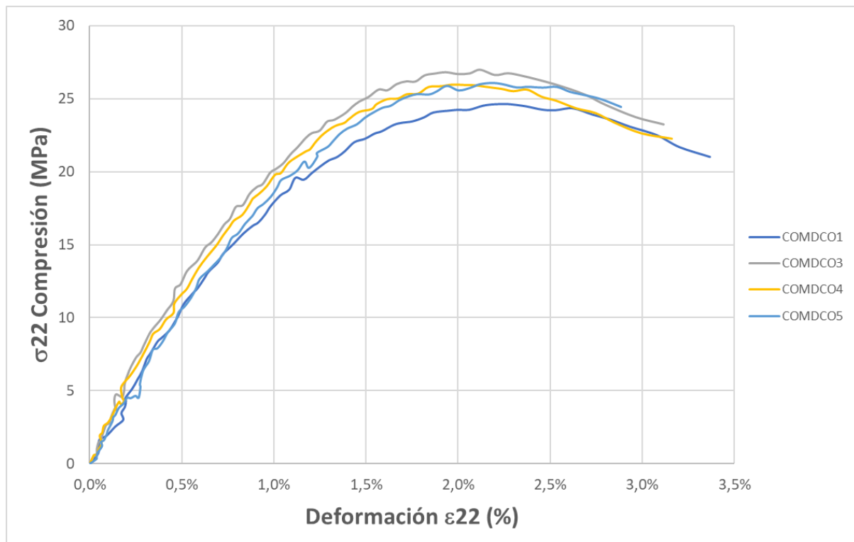
ILUSTRACIÓN 128. Curvas Resistencia a compresión-Deformación probetas COMDCO.
