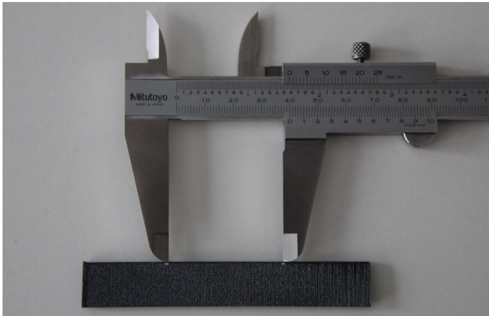
ILUSTRACIÓN 47. Marcas de referencia a 40 mm.
