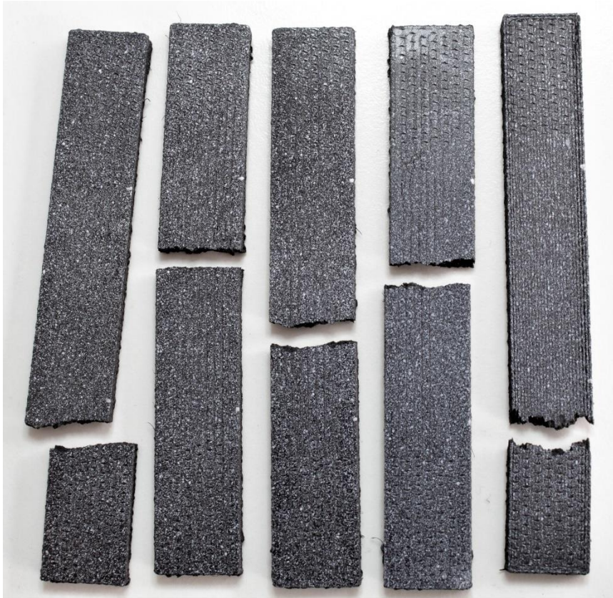
ILUSTRACIÓN 145. Rotura probetas TPPA.
