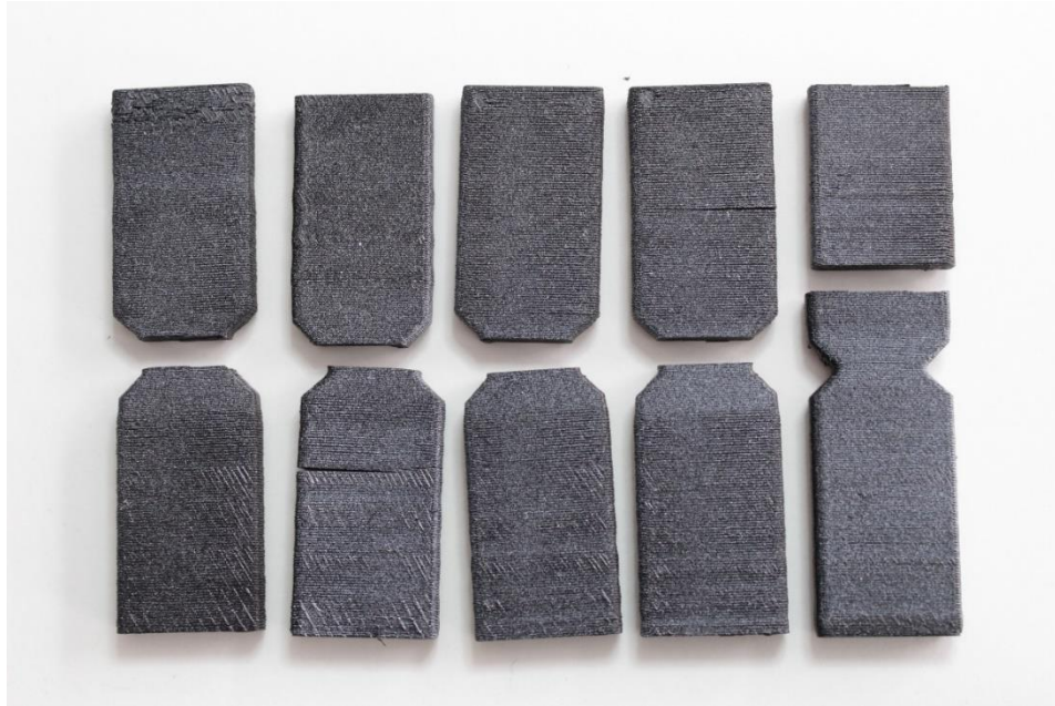
ILUSTRACIÓN 150. Rotura probetas CORVPET.
