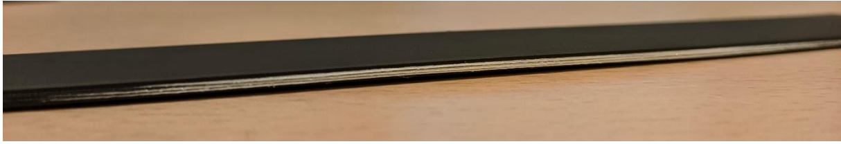
ILUSTRACIÓN 26. Fibra de vidrio descolocada fuera del plano de impresión.
