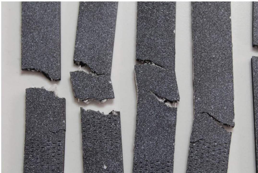
ILUSTRACIÓN 143. Rotura probetas TPO45°FV.
