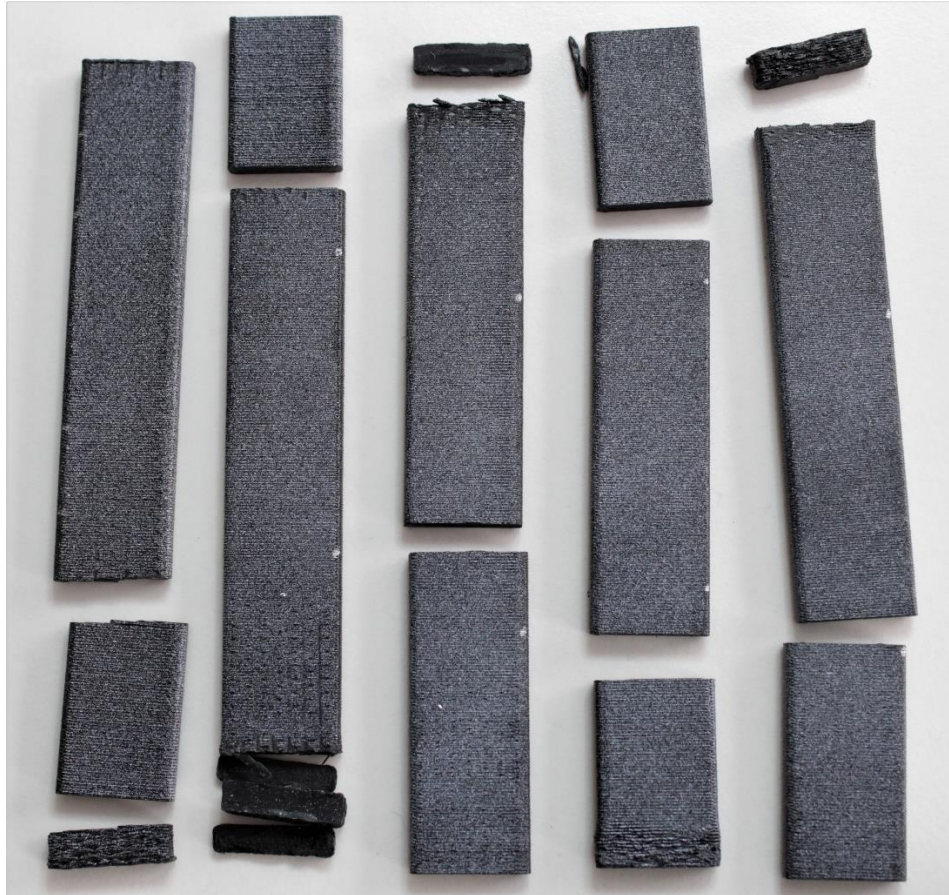
ILUSTRACIÓN 144. Rotura probetas TVPET.
