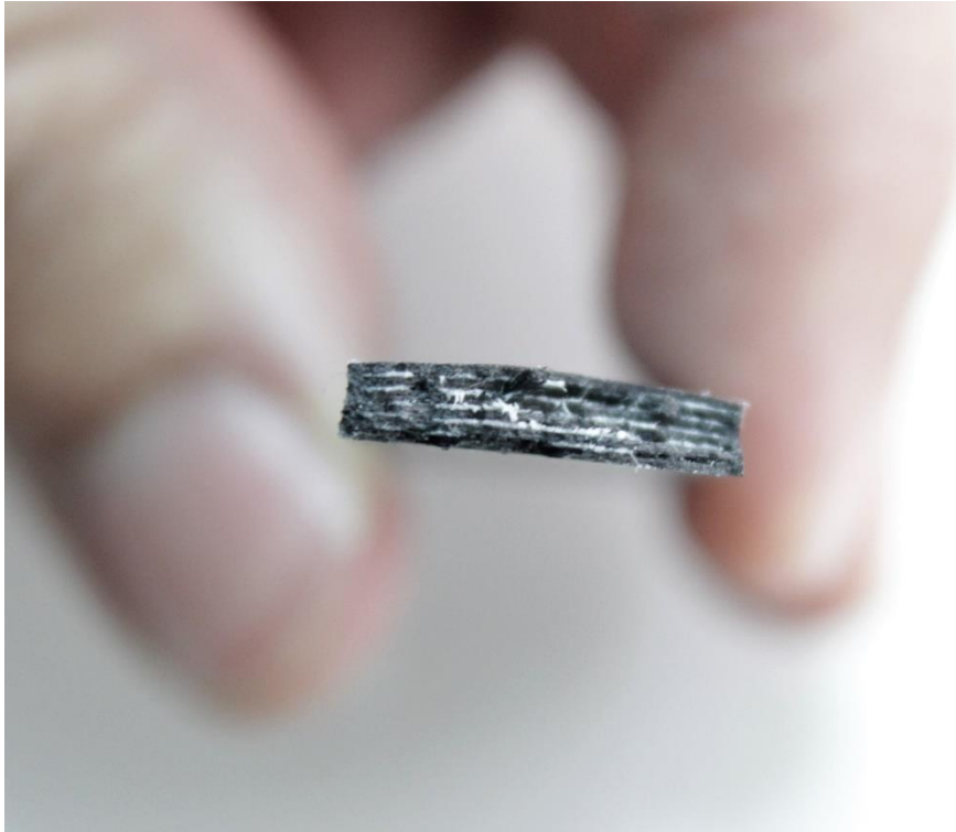
ILUSTRACIÓN 142. Sección de rotura probeta TPO0°FV.
