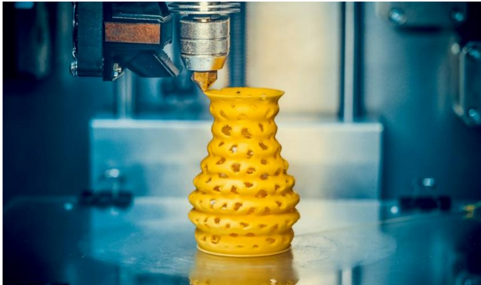
ILUSTRACIÓN 8. Pieza obtenida mediante FDM
