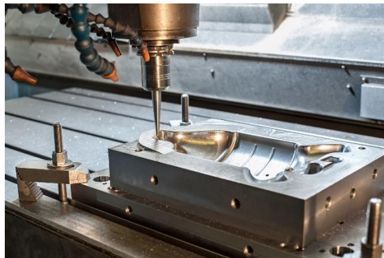
ILUSTRACIÓN 10. Fresadora CNC para recorte de pieza mediante UC
