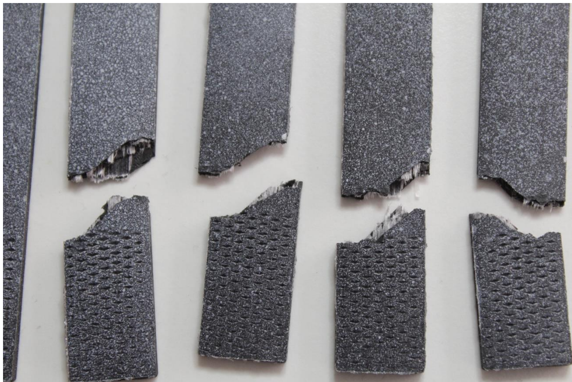
ILUSTRACIÓN 141. Rotura probetas TPO0°FV.
