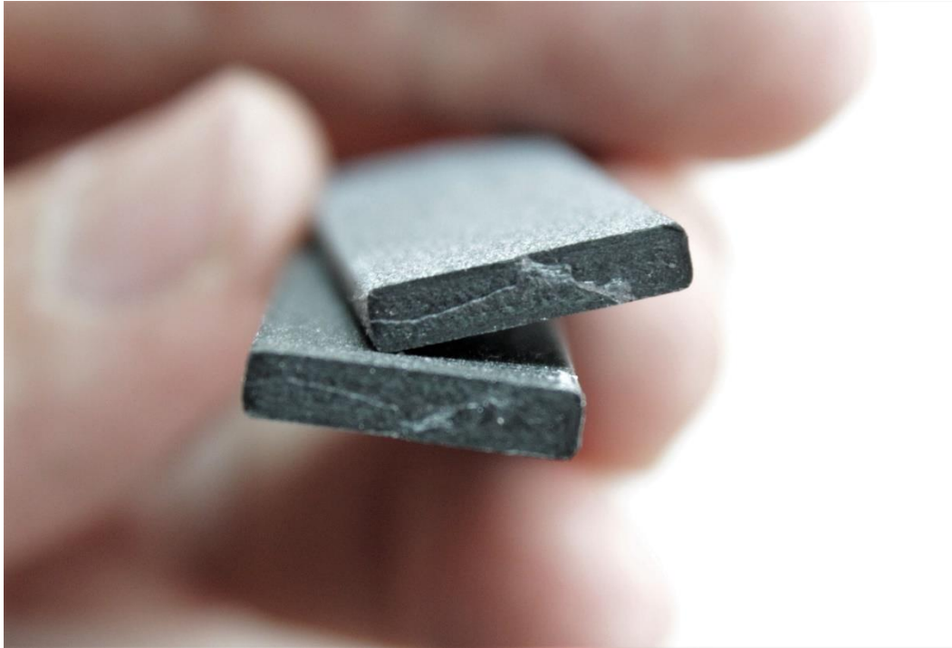
ILUSTRACIÓN 140. Sección de rotura probeta TVO.
