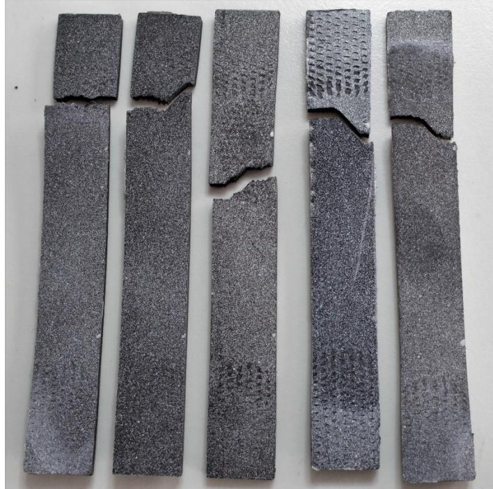
ILUSTRACIÓN 138. Rotura probetas TPO.
