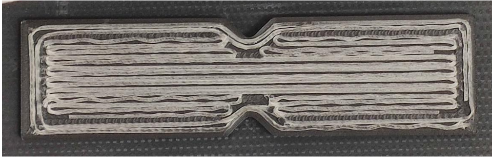
ILUSTRACIÓN 23. Capa interna de fibra de vidrio a 0^\circ durante el proceso de impresión.
