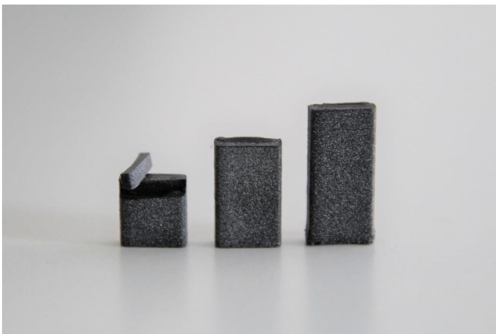
ILUSTRACIÓN 153. Rotura probeta COMVPA2.
