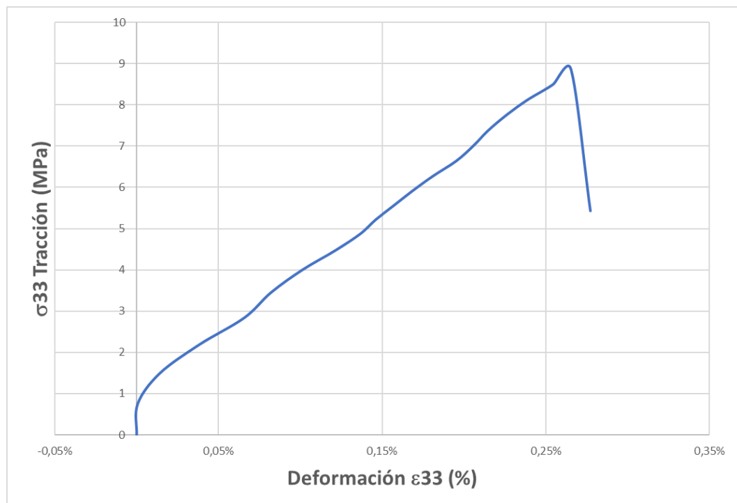
ILUSTRACIÓN 60. Tensión-Deformación sin procesar de la probeta TVPET1.
