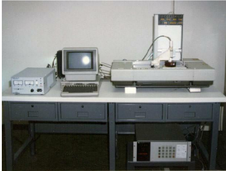
ILUSTRACIÓN 12. Primera impresora 3D de la historia diseñada por Chuck Hull
