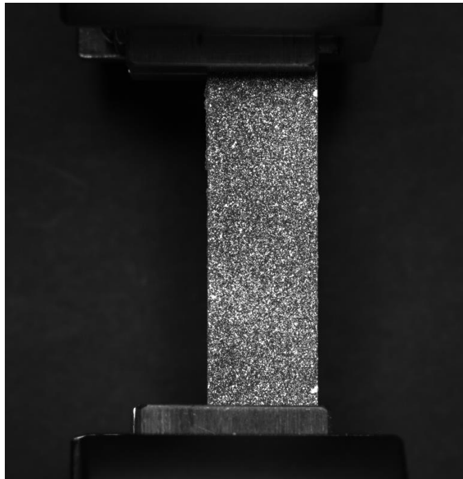
ILUSTRACIÓN 39. Fotografía previa al ensayo de tracción de una probeta.
