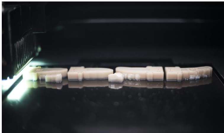
ILUSTRACIÓN 4. Fabricación de pieza mediante tecnología Polyjet
