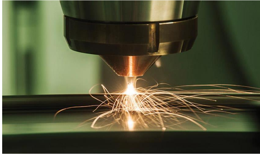
ILUSTRACIÓN 9. Deposición de energía focalizada
