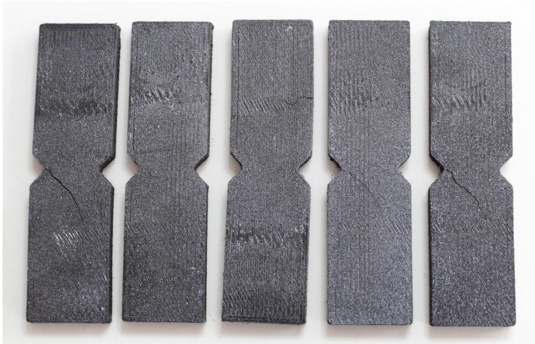
ILUSTRACIÓN 148. Rotura probetas CORPPET.
