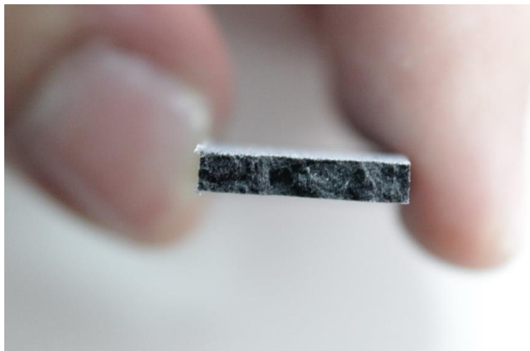
ILUSTRACIÓN 139. Sección de rotura probeta TPO.
