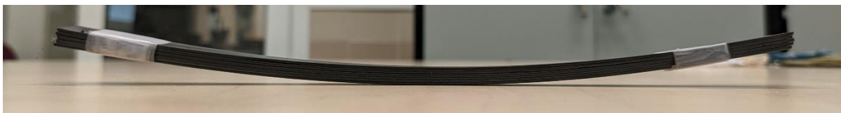
ILUSTRACIÓN 25. Warping en primer modelo para probetas a tracción.
