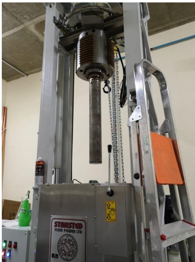
Imagen 7. Máquina de HPP de la Universidad de Jaén
