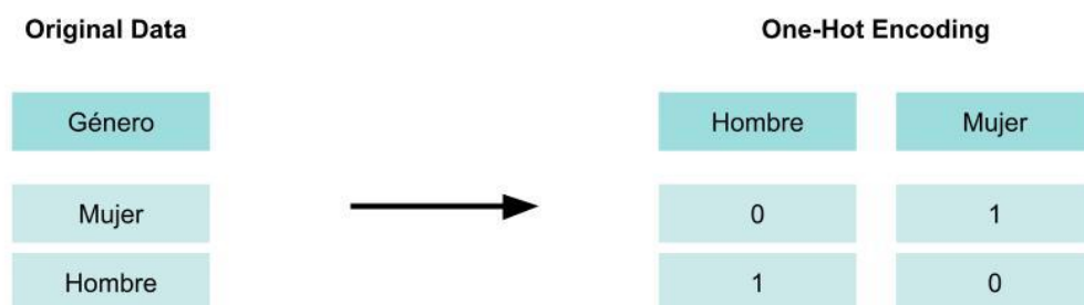
Ilustración 2.4 Imagen del funcionamiento del one-hot encoding
