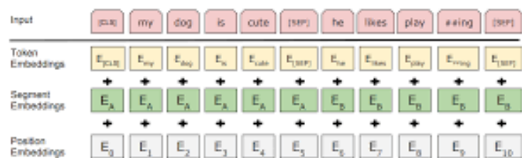
Ilustración 1.10 Imagen del funcionamiento tokenizador BERT [59]
