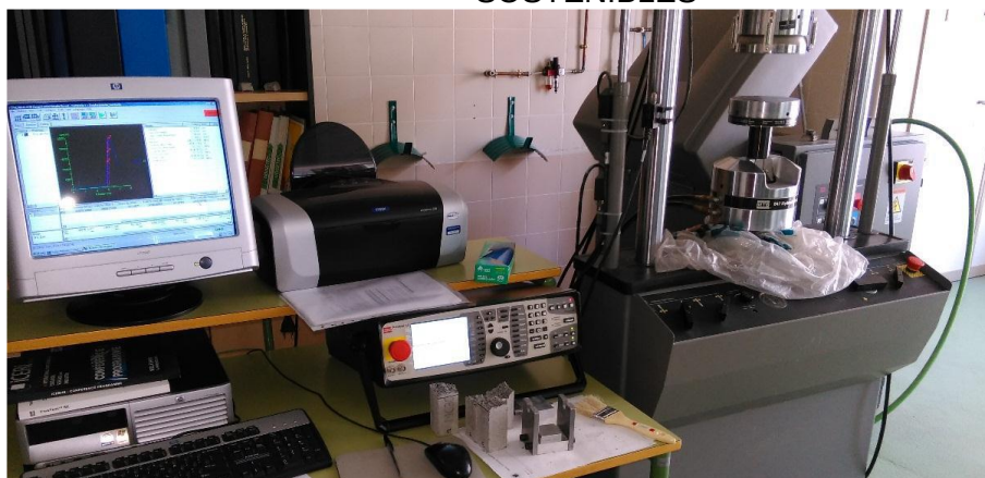
Figura 15. Ensayo de resistencia a compresión. Máquina de ensayo MTS 810 Material Testing Systems.
