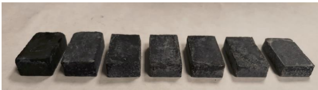
Figura 23. Probetas fabricadas a partir de las diferentes proporciones de materias primas (cenizas de cáscara de arroz-GeoSilex). (80CCA-20G, 70CCA-30G, 60CCA-40G, 50CCA-50G, 40CCA-60G, 30CCA-70G, 20CCA-80G).
