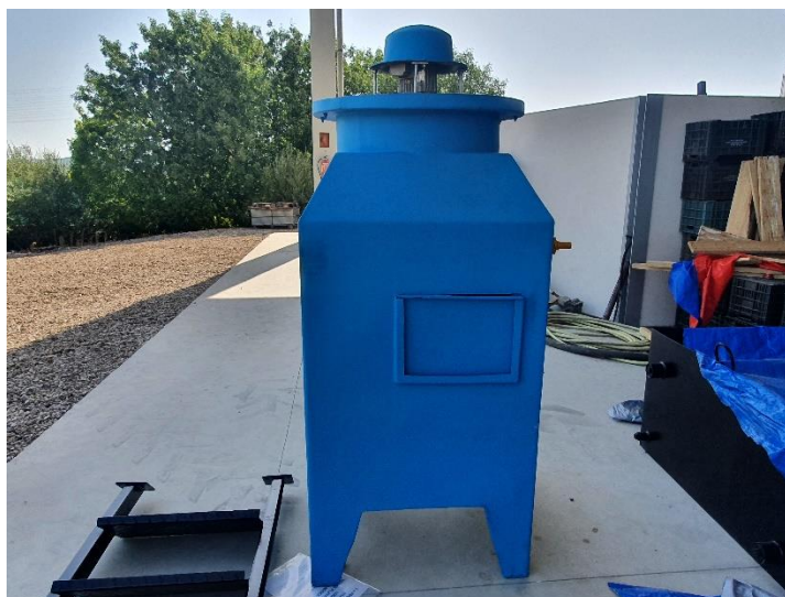
Figura 4.18: Torre de refrigeración
