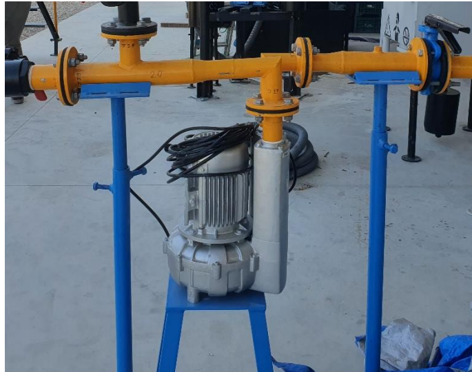
Figura 4.19: Blower del proyecto OLIVEN
