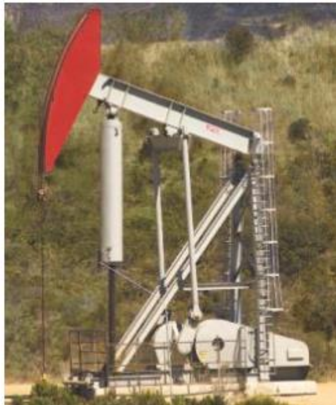
Figura 48. Unidad de bombeo balanceada por aire. Fuente: (Escalante, 2016)
