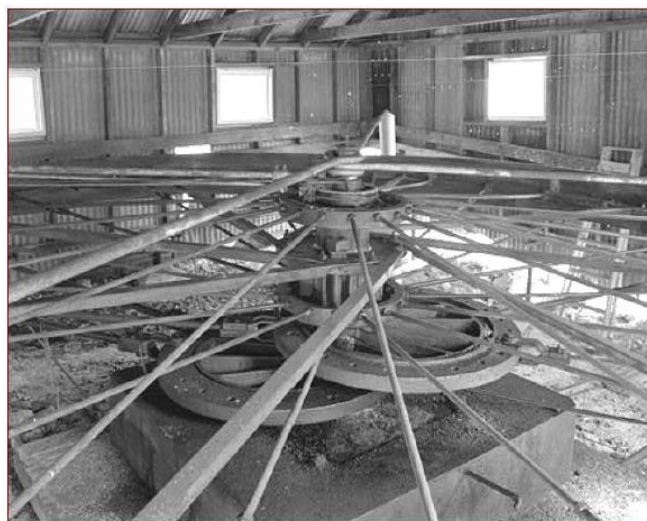
Figura 43. Foto de unidad de energía central de movimiento excéntrico. Se conserva en el museo Drake Well en Titusville, Pensilvania. Fuente: (The American Oil & Gas Historical Society, 2006)
