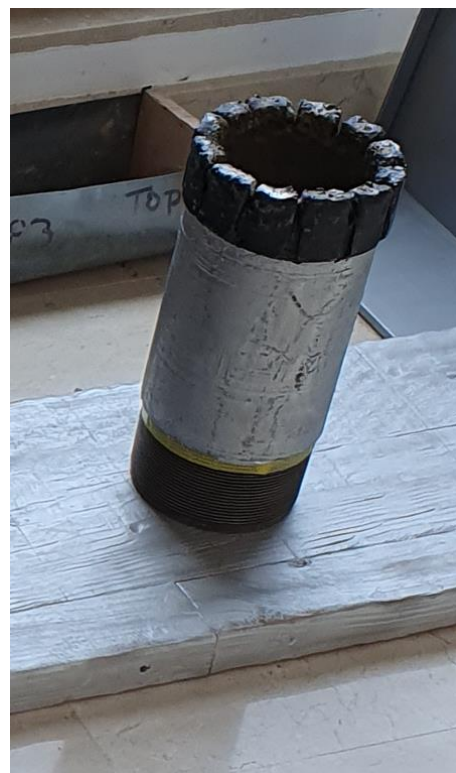
Figura 36 Izquierda: Barra de perforación y barrena utilizado en los pozos de Ayoluengo (en la sección se aprecian los estabilizadores para alargar la vida de las mismas). Derecha: Tubo instalado en el interior de los pozos de Ayoluengo para la extracción del petróleo. Fuente: (Lora, 2022)
