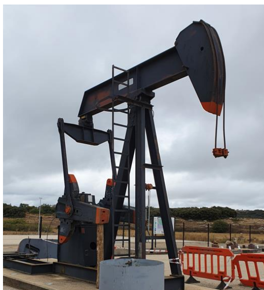
Figura 47. Unidad de bombeo convencional, llamada bomba de balancín. Unidad expuesta en el museo del petróleo de Sargentos de la Lora. Fuente: (Lora, 2022).
