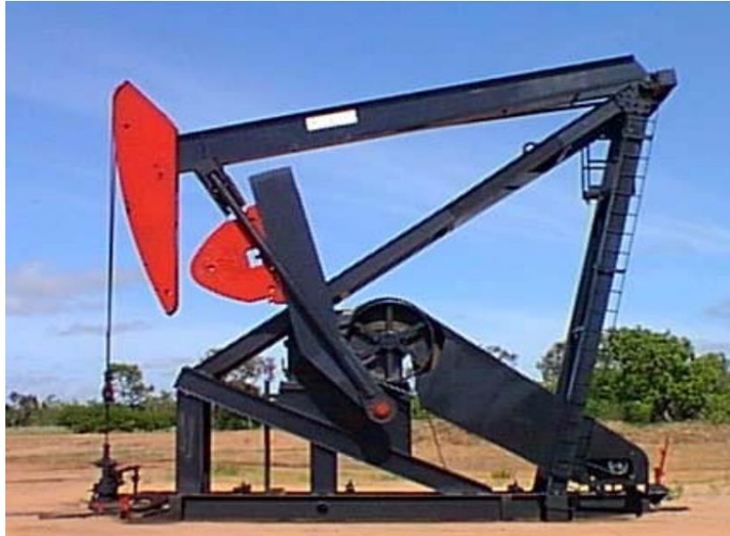
Figura 49. Unidad de bombeo Mark II. Fuente: (Partidas, 2003)
