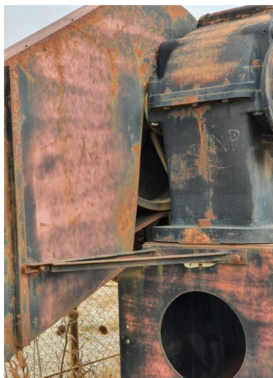
Figura 55. Izquierda: Detalle del motor de gas situado en la parte posterior de la máquina. Derecha: Detalle de la correa que conecta el motor con el mecanismo reductor. Fuente: (Lora, 2022)
