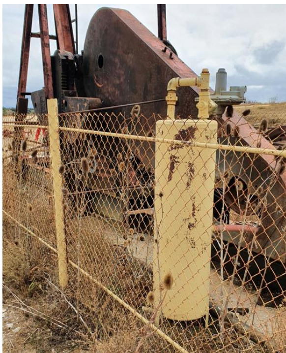
Figura 54. Izquierda: Depósito de gas situado en el exterior de la máquina para la estabilización de la presión antes de alimentar el motor. Derecha: Indicación en el campo del paso de la línea de gas desde el depósito hasta la planta. Fuente: (Lora, 2022)
