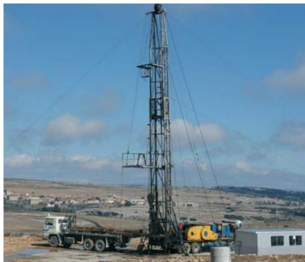
Figura 34. Acondicionamiento de un pozo en la explotación de Ayoluengo, torre de limpieza y mantenimiento de los pozos. Fuente: (Sociedad de Investigación y Explotación Minera de Castilla y León, 2009), (Lora, 2022).
