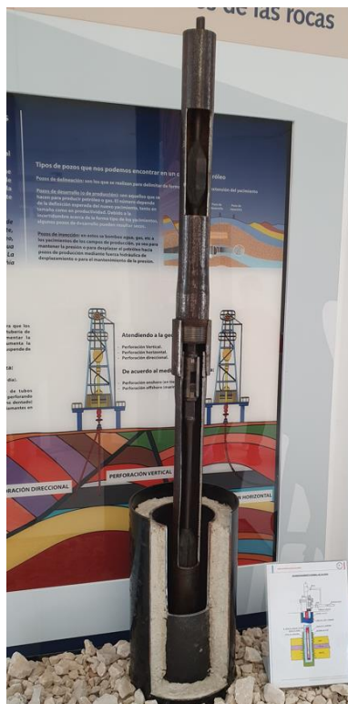
Figura 36 Izquierda: Barra de perforación y barrena utilizado en los pozos de Ayoluengo (en la sección se aprecian los estabilizadores para alargar la vida de las mismas). Derecha: Tubo instalado en el interior de los pozos de Ayoluengo para la extracción del petróleo. Fuente: (Lora, 2022)
