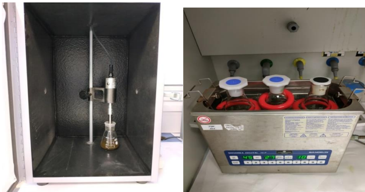
Imagen 3. Extractos metanólicos de Thymus vulgaris en proceso de extracción por la acción de la sonda y baño de ultrasonido, respectivamente.
