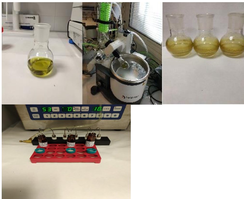
Imagen 4. Proceso de extracción de compuestos fenólicos. Extracto metanólico sometido a extracción por técnica de ultrasonido, vaporización del disolvente mediante presión reducida en el rotavapor, extracto húmedo resultante obtenido y vial topacio con extracto seco por la acción del cloroformo y nitrógeno.
