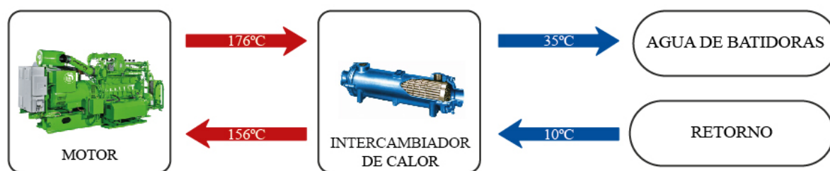
Figura 74: Esquema parte térmica 500
