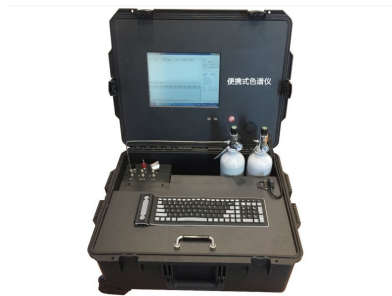
(b) Analizador de gases
