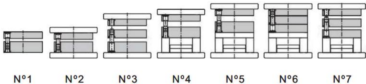
Ilustración 45. Tipos de moldes de inyección.
