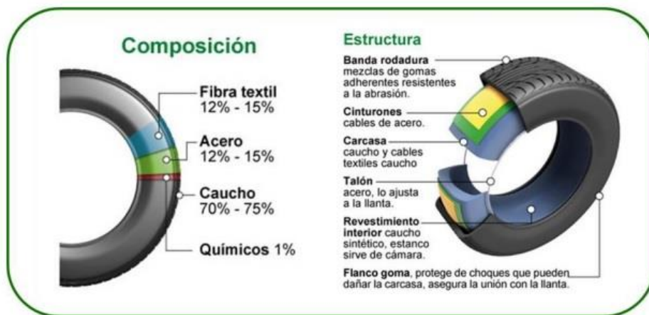
Figura 1 – Composición de las partes y materiales que contiene el neumático [1].
