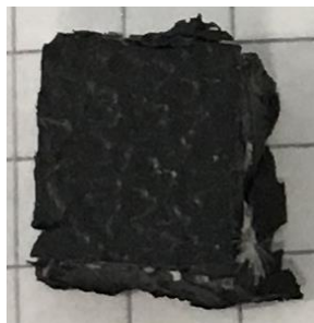
Figura 44 – Muestra de neumático utilizado para el análisis realizado con la bomba calorimétrica, suministrado por el Departamento de Ingeniería de Materiales (Campus Científico Tecnológico de Linares).
