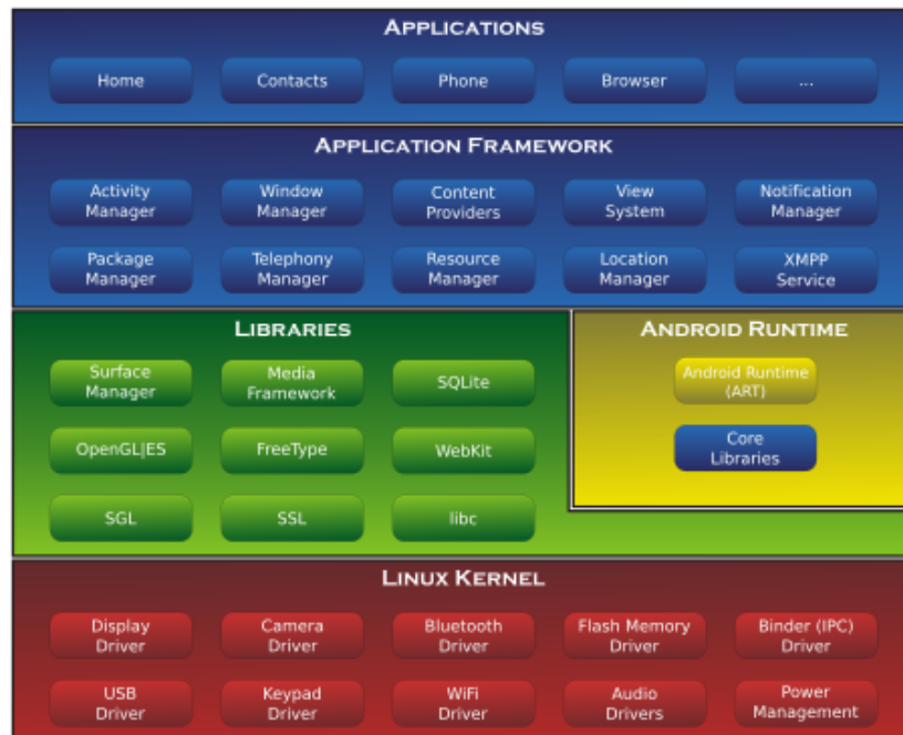
Ilustración 16. Representación gráfica de las capas de la arquitectura de Android [30]
