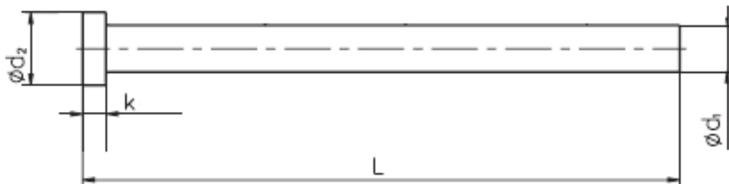
Figura 65. Plano paramétrico del expulsor
