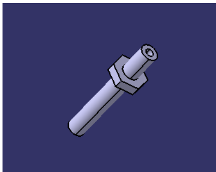
Figura 70. Boquilla de refrigeración
