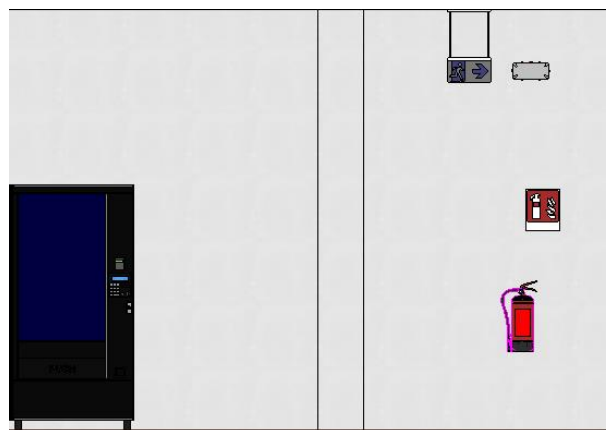
Figura 81: Disposición señalización y luminaria.
