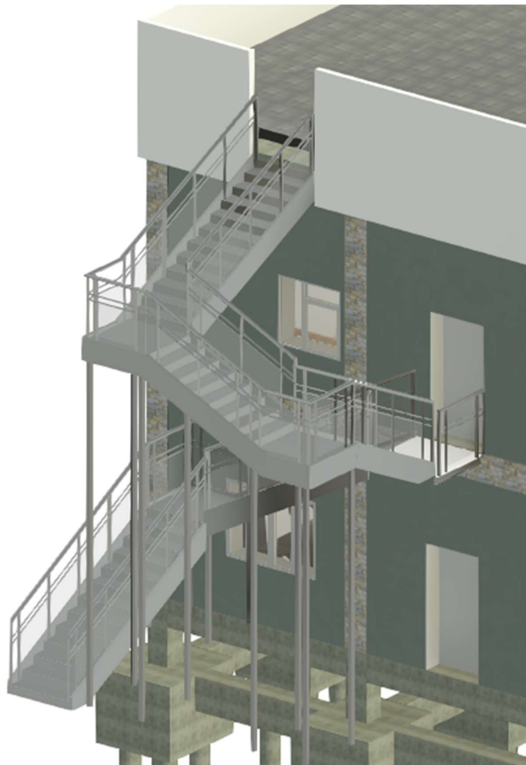
Ilustración 60: Escaleras de evacuación y acceso a cubierta - Residencia
