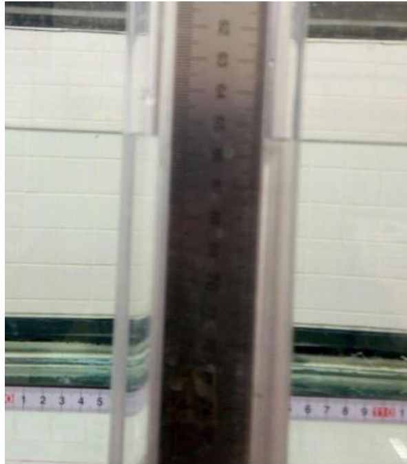
Ilustración 9. Tubos piezométricos y sistema de medición.
