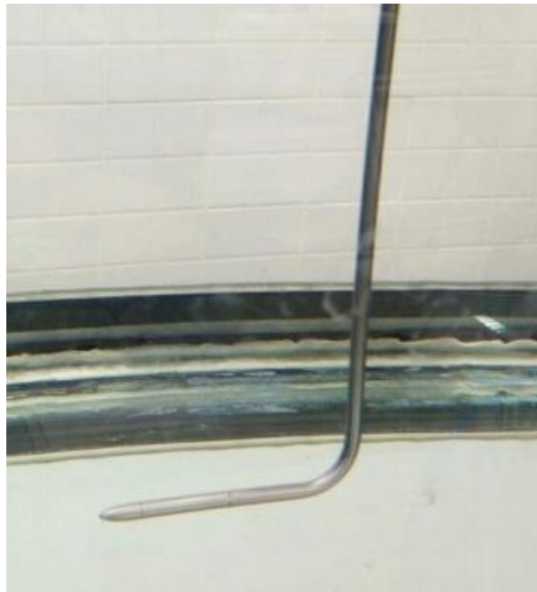
Ilustración 8. Tubo de Pitot.
