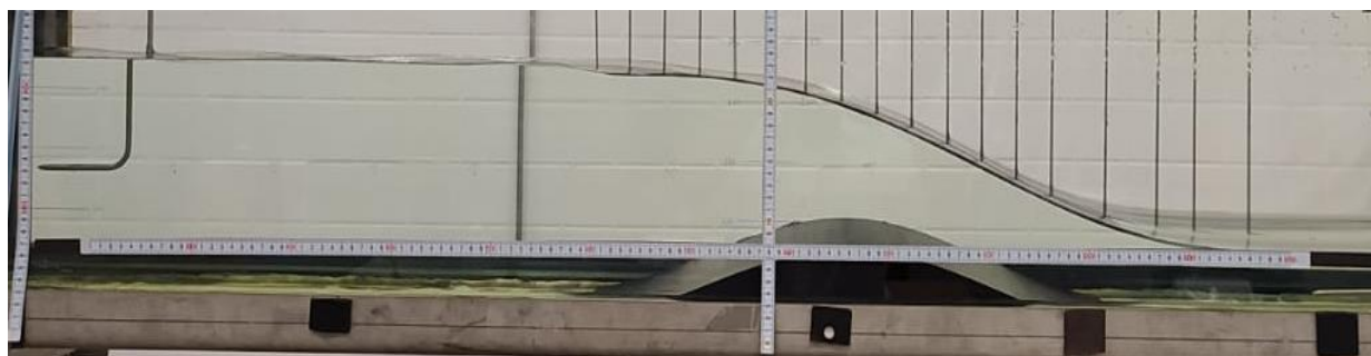
Ilustración 79. Contorno del calado del ensayo subcrítico-supercrítico en laboratorio con resalto de 75 mm.
