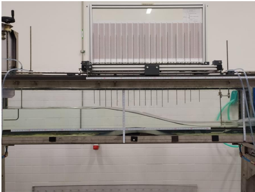
Ilustración 16. Ensayo obstáculo de fondo 50 mm a 50 Hz de frecuencia.
