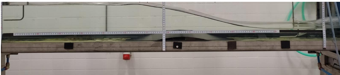
Ilustración 76. Contorno del calado del ensayo subcrítico-supercrítico en laboratorio con resalto de 50 mm.
